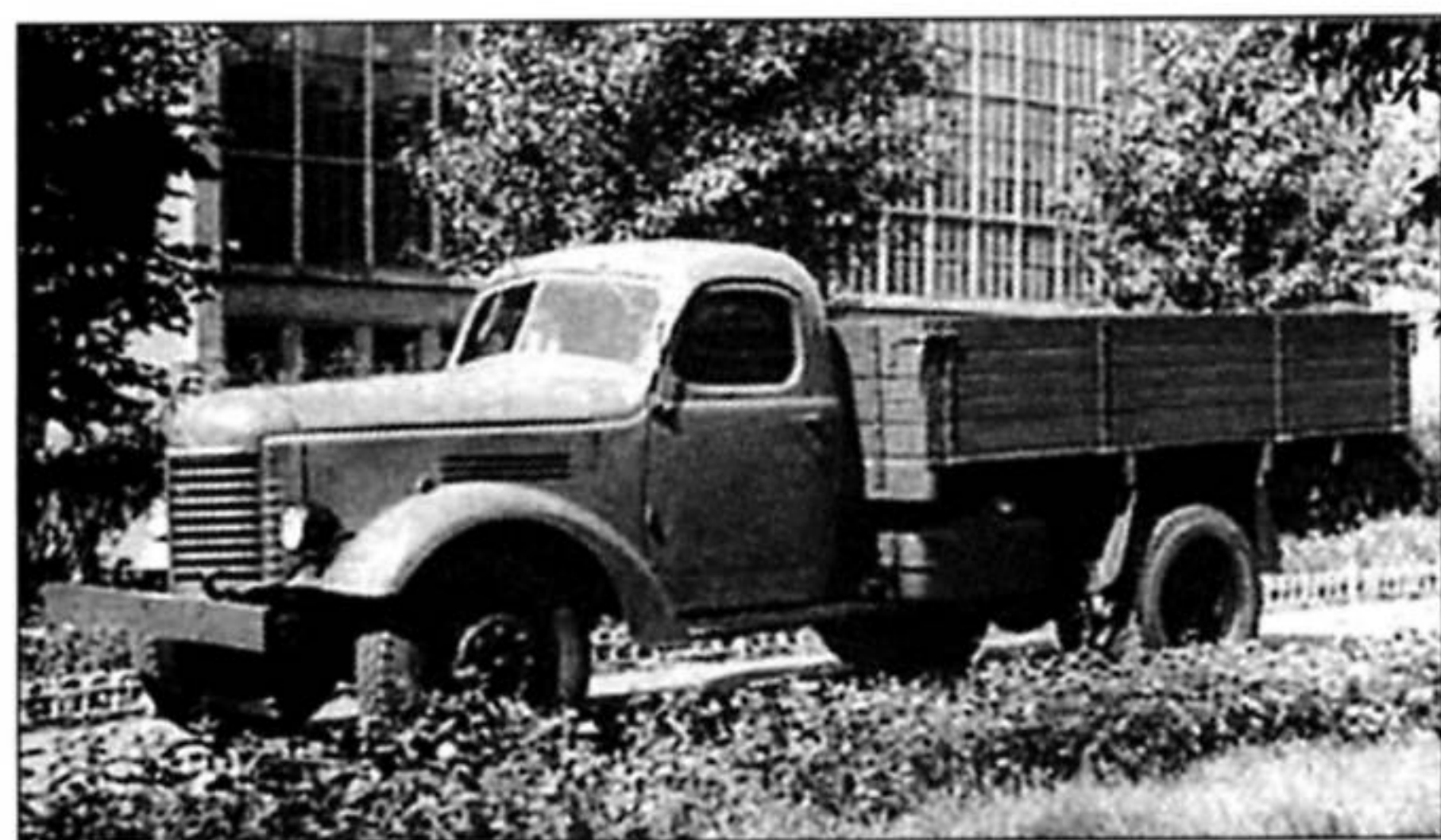
ЗиС-150 с кабиной второго поколения - цельнометаллической (ZiS-150 truck equipped with all-metal cab of second generation)
