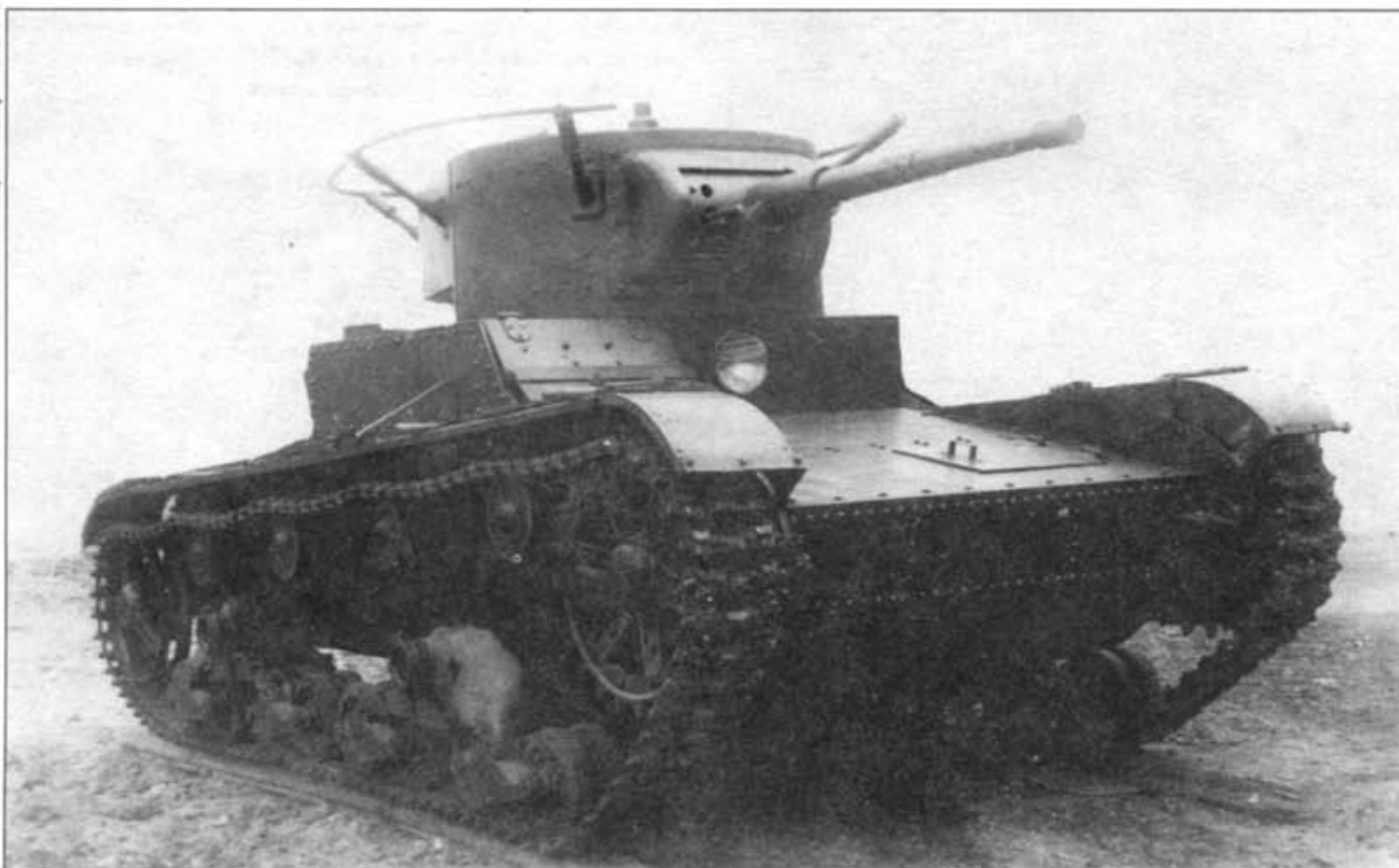
Радиотанк Т-26 обр. 1933 г. Эта машина имеет черты как ранних моделей: трансмиссионный люк, откидывающийся вправо, фара без броневого кожуха, так и поздних — штампованный лобовой щит башни и съемные бандажные опорные катки. НИИТПолигон, 1940 г.
