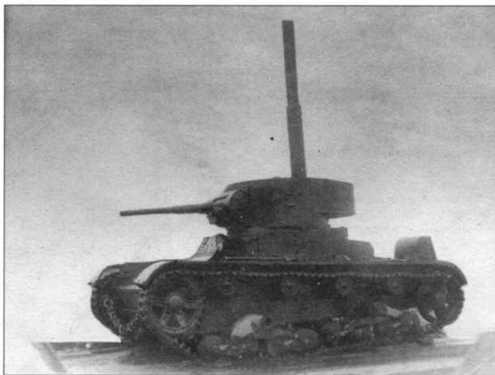
Танки подводного хода, выполненные на базе Т-26. В в е р х у: Т-26ПХ конструкции НАТИ, в н и з у: Т-26ПХ конструкции НИБТПолигона
