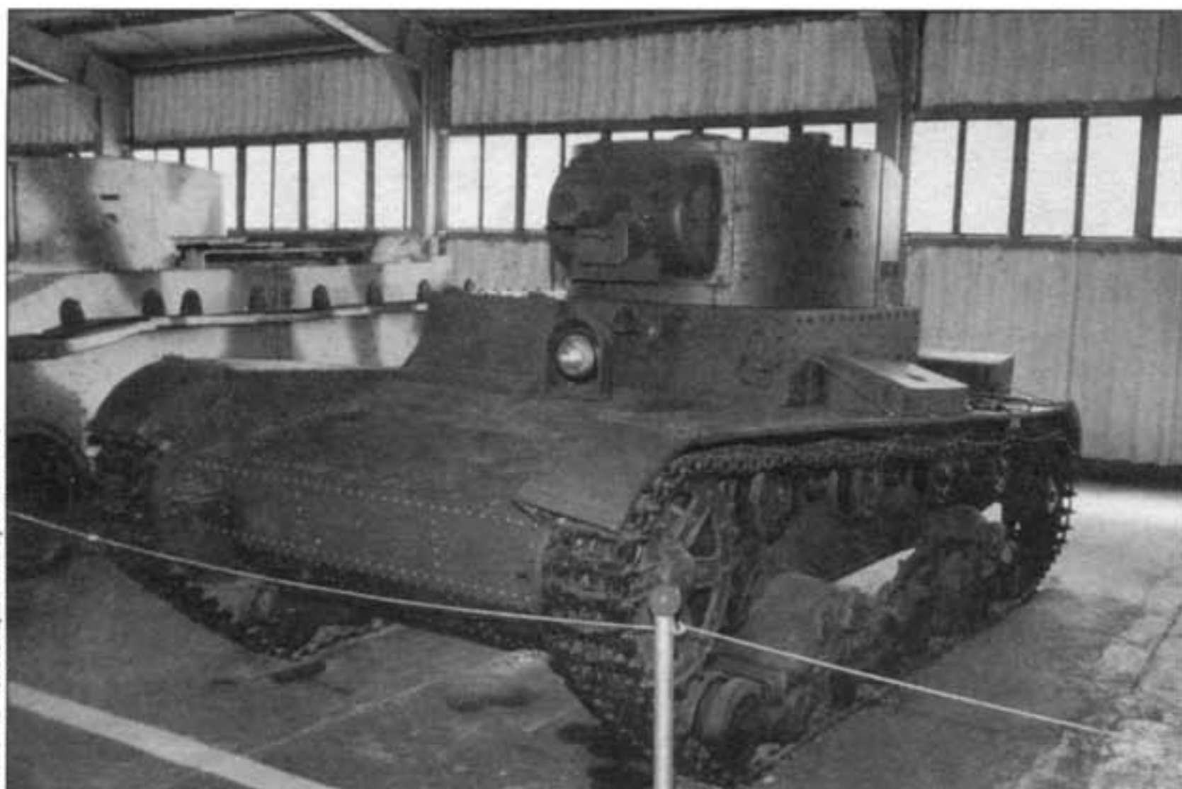
Танк управления телемеханической группы. Штатное вооружение демонтировано. Военно-исторический музей БТВТ, Кубинка, 2002 г.
