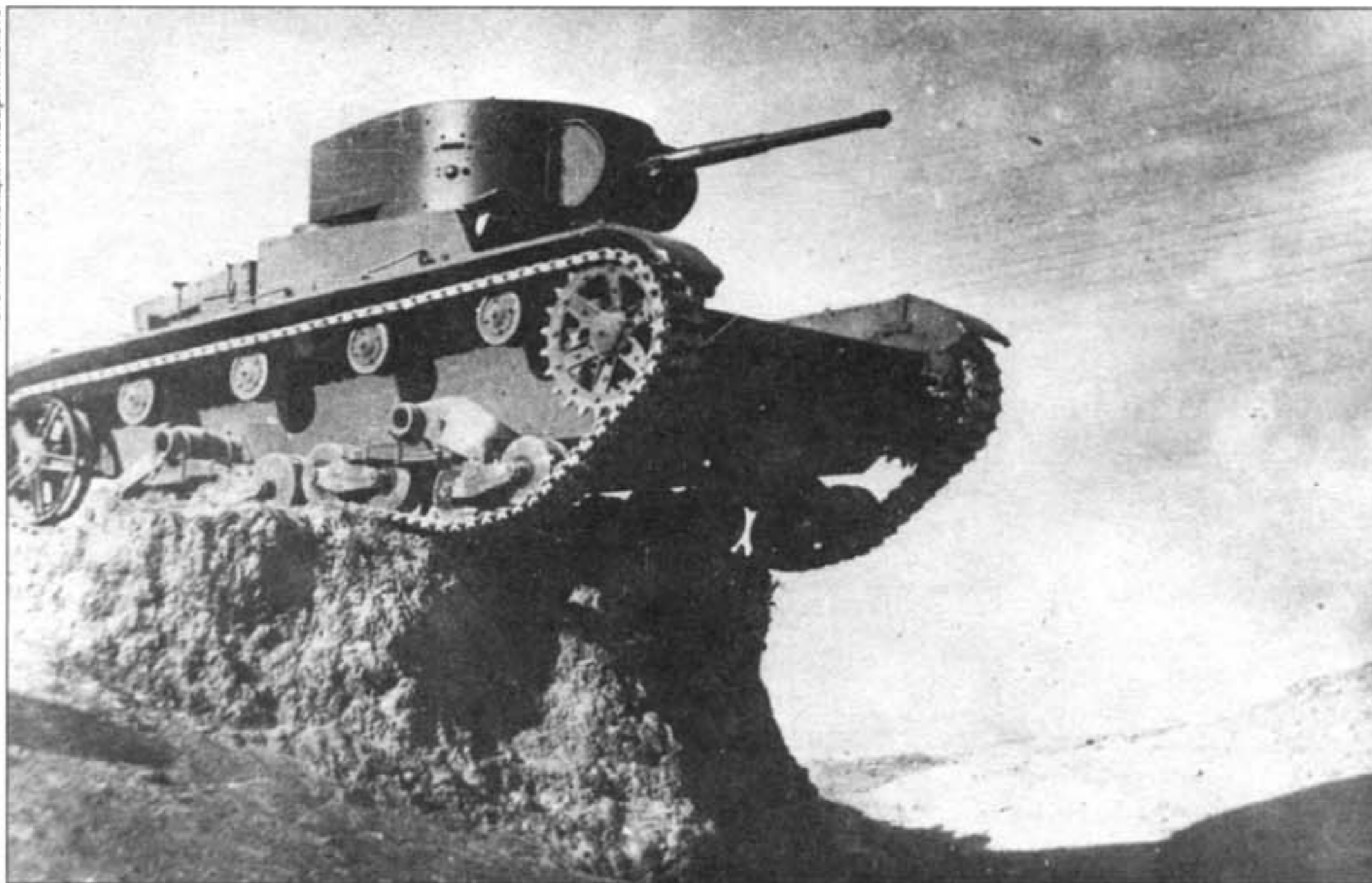
Т-26 ранних выпусков во время занятий на пересеченной местности. Башня танка имеет сварную маску пушки (лобовой щит)
