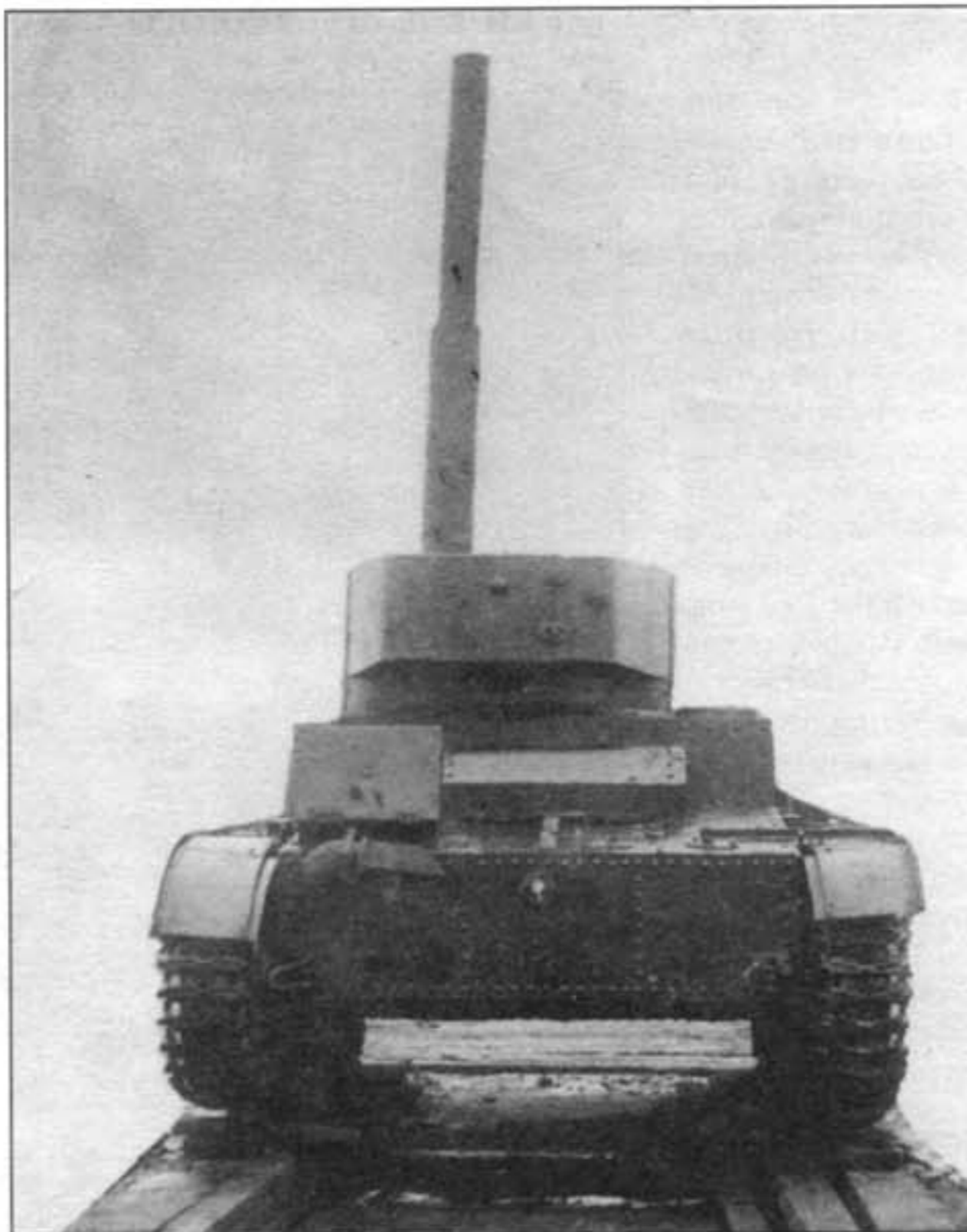
Т-26ПХ конструкции НИБТПолигона. Вид сзади. Хорошо видны поднятая коробка масляного радиатора и воздушный колпак, закрытый дверцей
