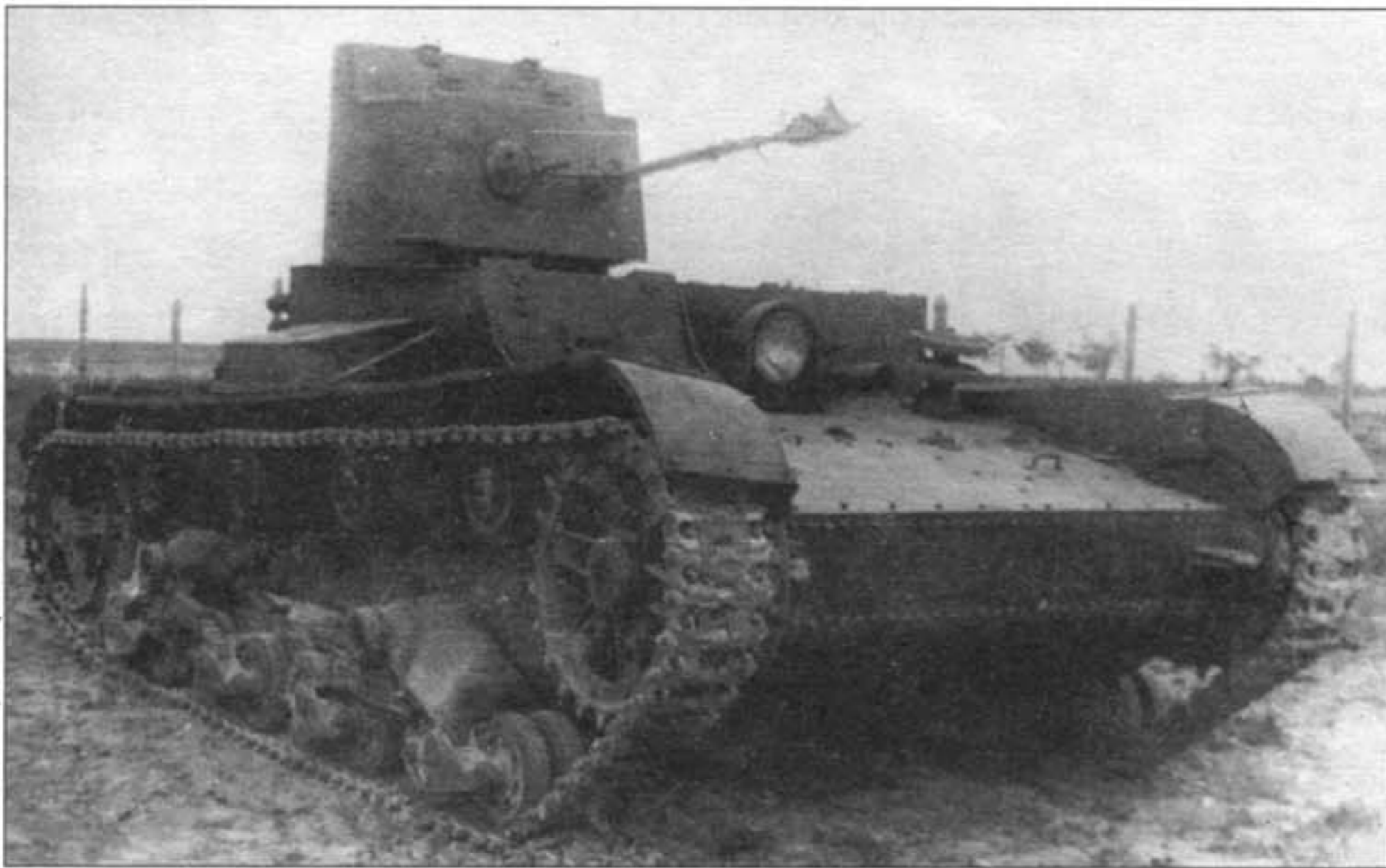
Химический танк ХТ-26, прошедший частичную модернизацию (в ходовой части установлены опорные катки со съемными бандажами, фара в откидном колпаке). НИБТПолигон, 1940 г.
