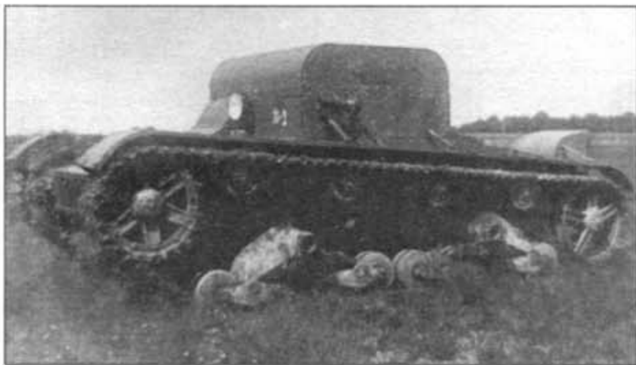
Артиллерийский тягач Т-26Т во время испытаний на НИИБТПолигоне
