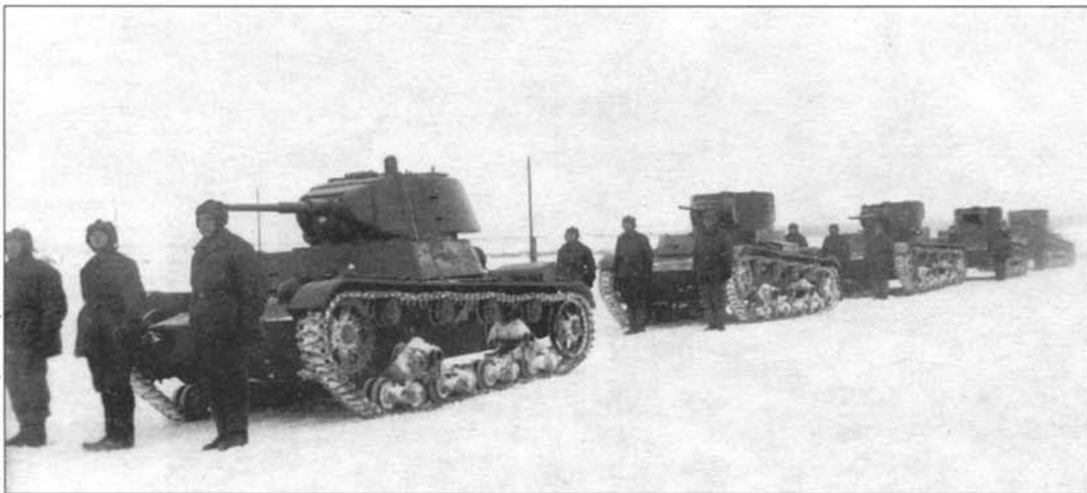
Танковый взвод на учебном поле. Головная машина — Т-26 обр. 1939 г., остальные — Т-26 обр. 1933 г.
