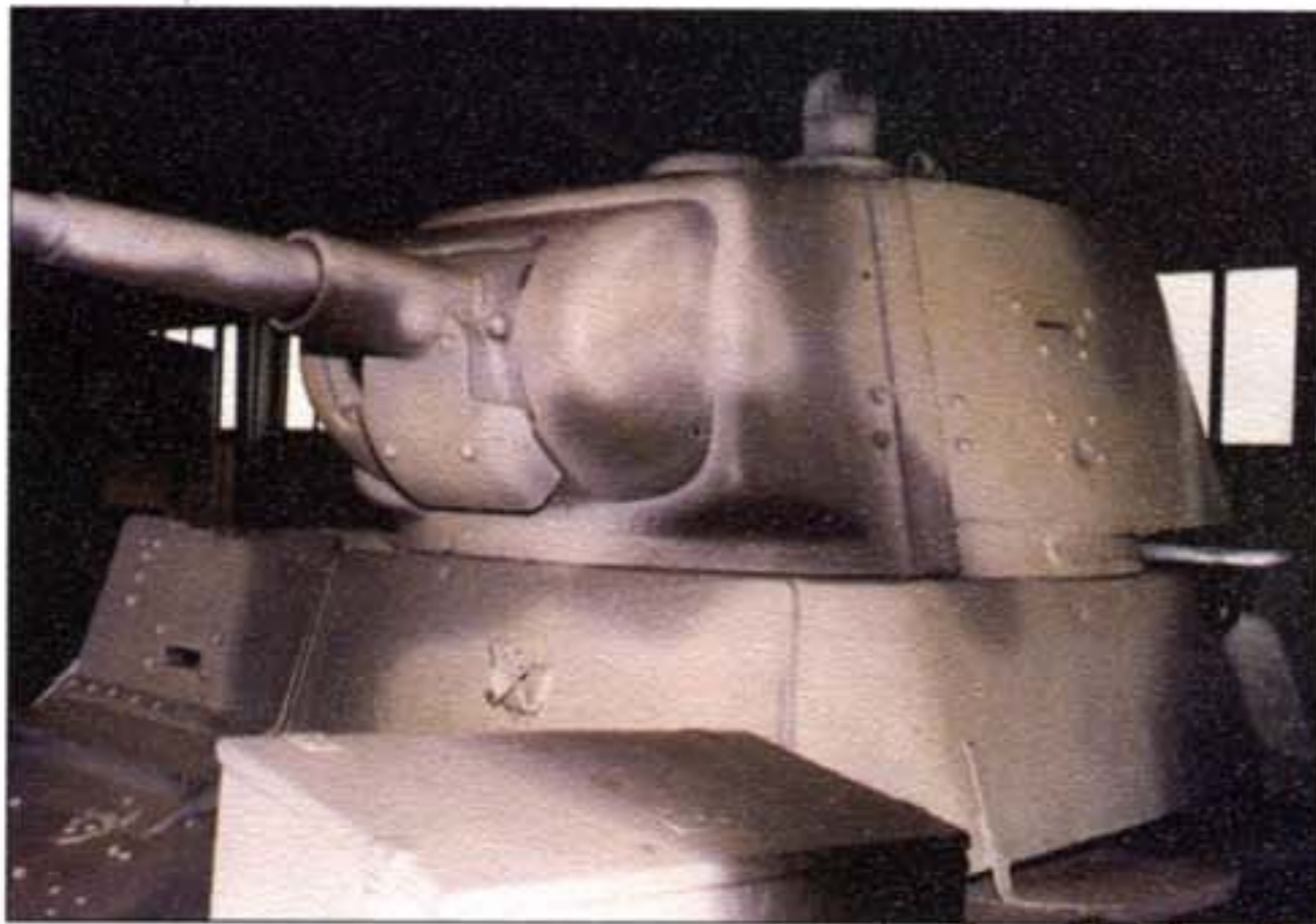
Легкий танк Т-26 обр. 1939 г. в экспозиции Военно-исторического музея бронетанковой техники и вооружения в Кубинке. У этой машины башня имеет штампованный лобовой щит
