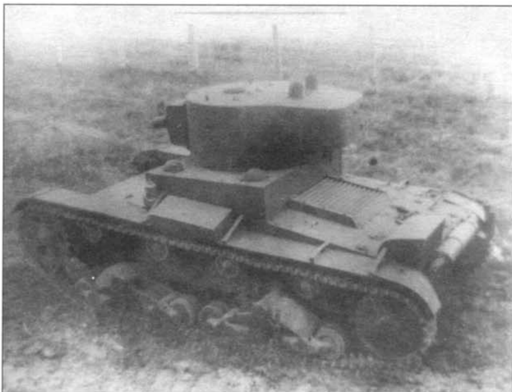
Телетанк ХТ-130. На крыше башни хорошо видны два антенных ввода. НИБТПолигон, 1940 г.
