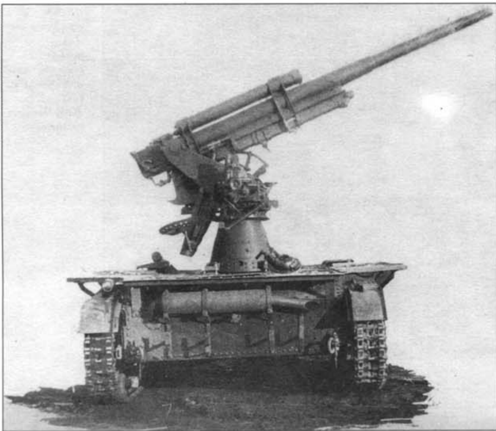
Самоходная установка СУ-6 в боевом положении
